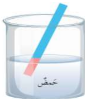
الشكل (4): تغير لون ورق تباع الشمسي في المحلول الحمضي.
